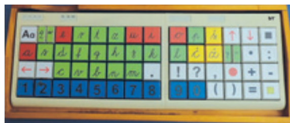
Slika 18: Tipkovnica z malo tiskano abecedo 7 in simboloma za na tipke, za črki b in d 8
