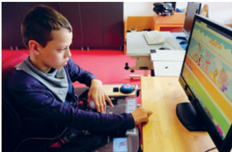
Slika 10: Premikanje miške s pomočjo komande elektromotornega vozička in stikala
