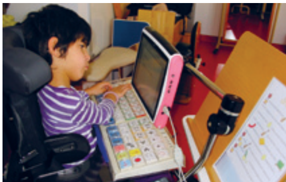
Slika 35: Uporaba prilagojene tipkovnice in komunikatorja ter stojala za knjigo
