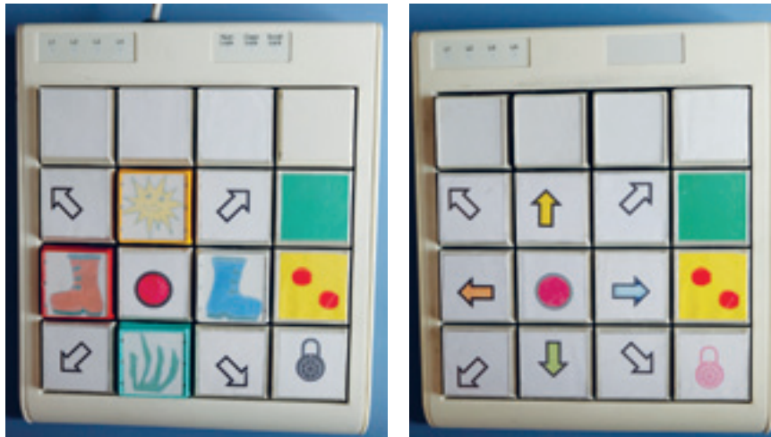
Sliki 6 in 7: Simulacija miške na tipkovnici z večjimi tipkami, ki je na začetku opremljena s simboli, ki jih otrok lažje razume (sonce, trava, rdeč in moder čevelj); te kasneje zamenjamo s puščicami. 2
