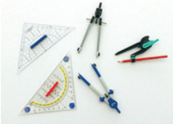
Slika 10: Primerno šestilo in geotrikotnik
