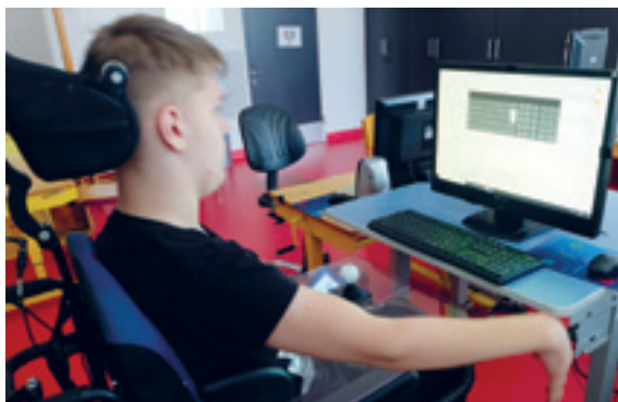
Slika 37: Pisanje z gibi glave in enim stikalom
